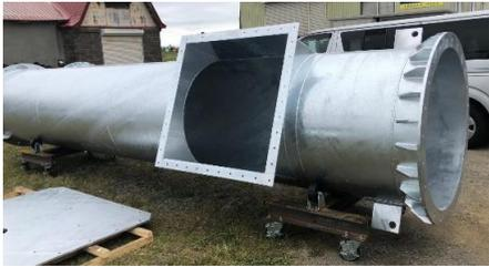
鋼製煙突(ライニング材挿入前)
